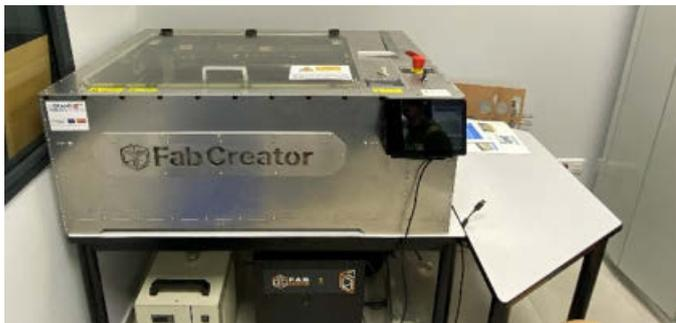
L'équipement phare du FabLab est, sans conteste, la machine de découpe laser. Elle permet de réaliser de nombreux projets de découpe et/ou gravure sur une large gamme de matériaux tels que le bois, le cuir, la feutrine, le plexiglas ou encore l'ardoise...
